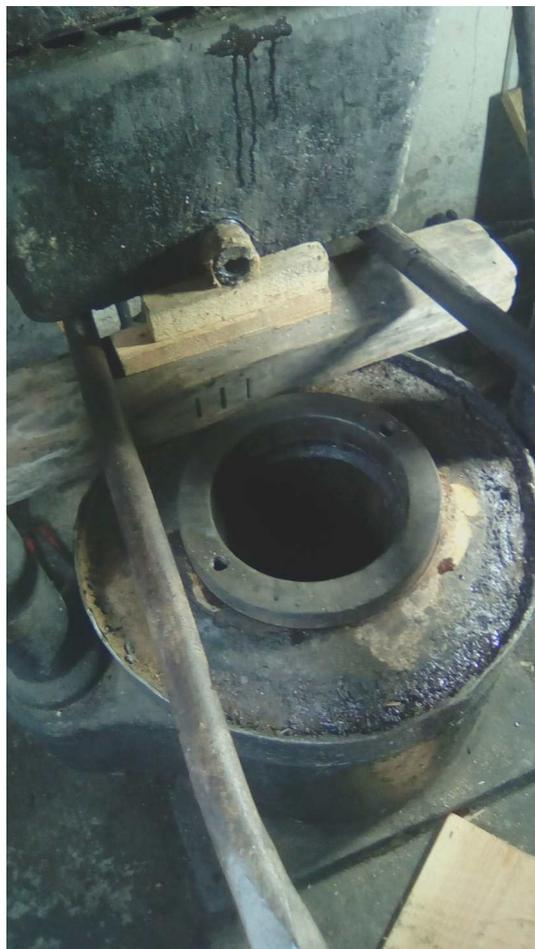
Et voilà, il s'est complètement enfoncé dans le cylindre. Il faut encore réajuster dessus la cuve de pressage, repositionner le «mouton», et on pourra mettre en route la pompe hydraulique pour tester la bonne étanchéité du joint.
