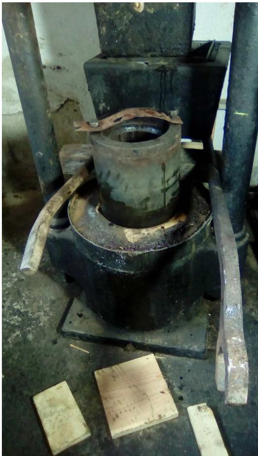
Le piston, décroché du palan, repose sur la lèvre du joint, la bride de manipulation est encore en place. On distingue derrière, la cuve de pressage qui a été mise en attente, reposant sur des barres à mines et surmontée de son mouton coulissant.
